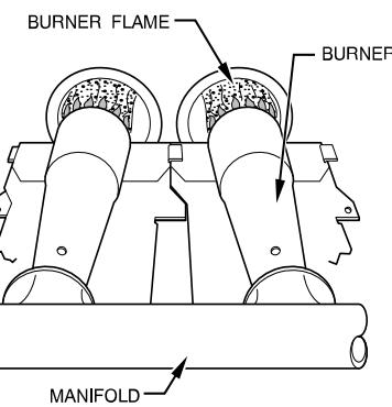
**Fig. 64 – Burner Flame**
